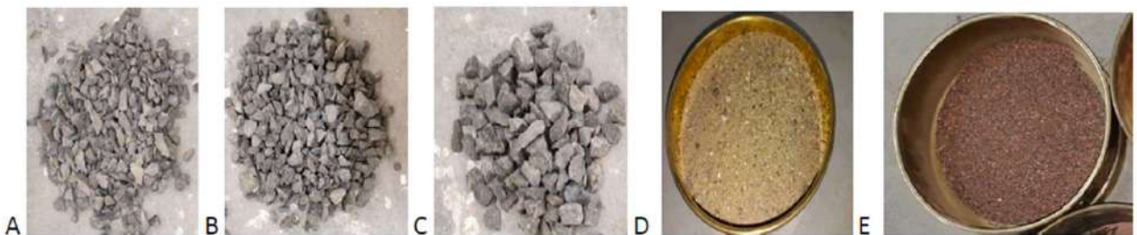
Fig. 4: Pictures of (A) CA (10 mm) (B) CA (12.5 mm) (C) CA (20 mm) (D) FA (E) RB sand.
